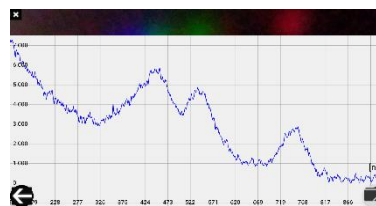
Figura 3 – Espectro obtido após a luz branca atravessar uma amostra com corante azul
